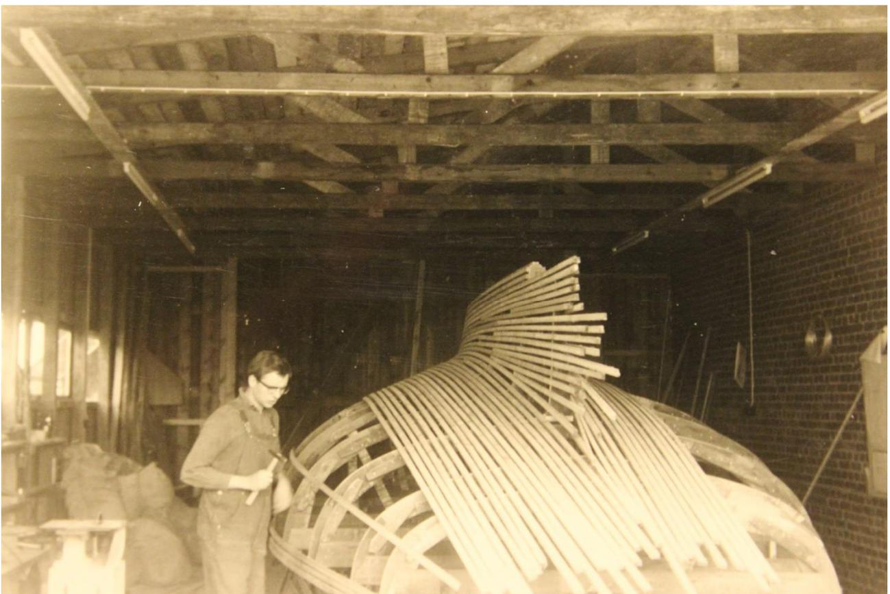
Der beplankte Rumpf wurde, um eine gute Haftung mit der Gipsschicht zu bekommen mit Jutesäcken und Drahtgewebe verstärkt.
